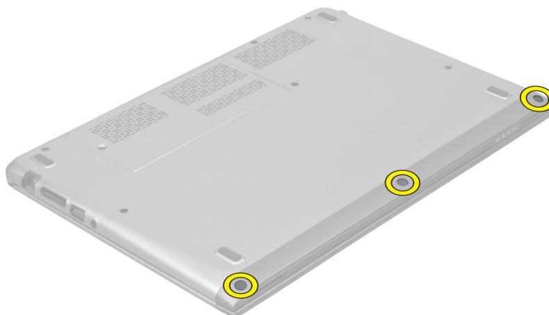
4. Entfernen Sie die Schrauben, mit denen die Handballenstütze am Computer befestigt ist.
