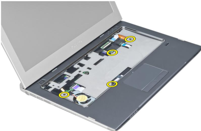
8. Lösen Sie die Handballenstütze, indem Sie die Handballenstütze entlang ihrer Kante aufhebeln.
