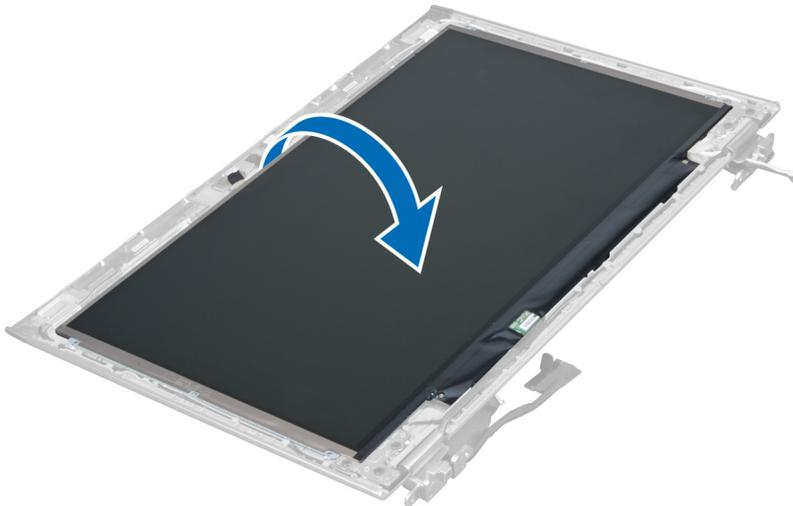
6. Legen Sie den Bildschirm mit seiner Vorderseite nach unten zeigend ab, um auf die an ihm angeschlossenen Bildschirm- und Kamerakabel zuzugreifen.
