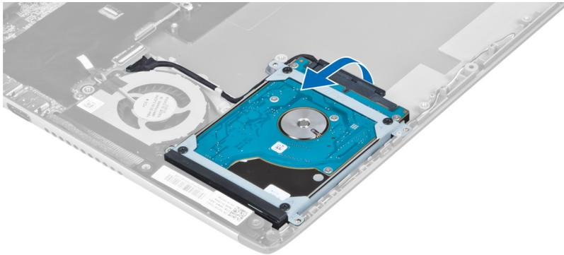
5. Trennen Sie das Festplattenlaufwerkkabel vom Festplattenlaufwerk und entfernen das Festplattenlaufwerk aus dem Computer.
