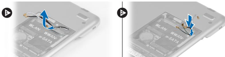
4. Trennen Sie das Bildschirmkabel von der Systemplatine und entfernen Sie die Schrauben, mit denen die Bildschirmbaugruppe am Computer befestigt ist.
